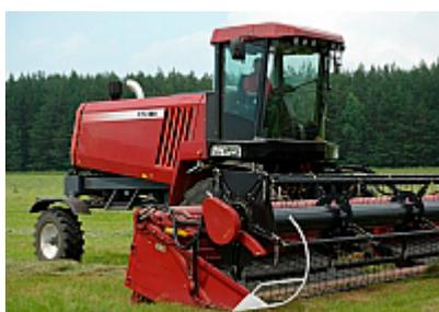
**Самоходная косилка CS200** позволяет эффективно решать задачи раздельной уборки зерновых колосовых, зернобобовых, крупяных культур, а также заготовки кормов из трав. Косилка с валковой транспортной жаткой (захватом 9,2 м) обеспечивает скашивание растений и их укладку в центральный, левосторонний или правосторонний валок, может с двух проходов формировать сдвоенный валок шириной до 4 метров. Для кошения трав, кроме валковой жатки, предусмотрена возможность работы с 4-метровой роторной жаткой.
