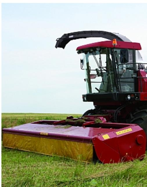
**Жатка для трав КВК-1-0500000** предназначена для скашивания сеяных и естественных трав. Жатка подходит для эффективной и простой обработки всех типов трав и травосмесей.
