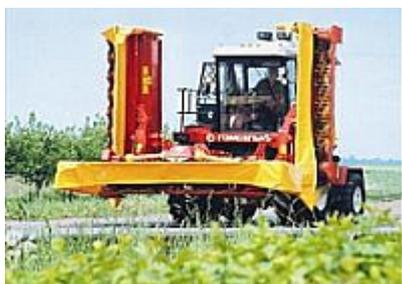
Косилка-плющилка КПР-9 «СН90» предназначена для кошения зеленых сеяных и естественных трав с одновременным плющением и укладкой скошенной массы на стерню в три валки. Косилка может быть использована для кошения трав без плющения с укладкой скошенной массы в валки.
