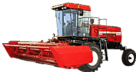
**Самоходная косилка CS100** является самоходной сельскохозяйственной машиной, предназначена для скашивания, плющения и укладки в валок по центру машины трав, зерновых колосовых, зернобобовых, крупяных и других культур на полях с уклоном до 8° в разных почвенно-климатических условиях с умеренным климатом, кроме почв с низкой несущей способностью. Косилка состоит из шасси и жатки.
