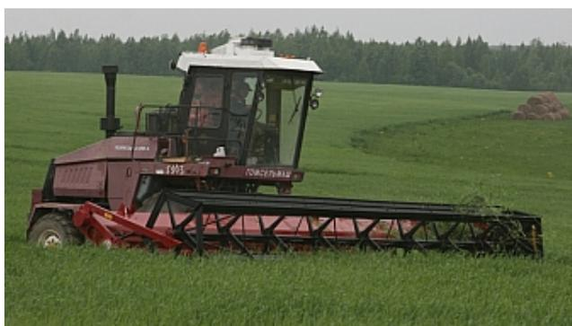
**Жатки валковые зерновые ЖВЗ-7У, ЖВЗ-9У** предназначены для скашивания и укладки стеблей зерновых культур на стерню в валок при раздельном способе уборки. Жатки ЖВЗ-7У и ЖВЗ-9У агрегируются с универсальными энергетическими средствами УЭС-2-250А и УЭС-2-280А и их модификациями.
