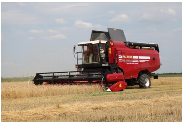
**Жатки ЖЗК** предназначены для уборки зерновых колосовых культур, а с применением специальных приспособлений также для уборки рапса, зернобобовых и крупяных культур. Жатки агрегируются с комбайнами GS575, K3C-7, GS812, GS10, GS12, GS1218A1, GS14, GS16.
