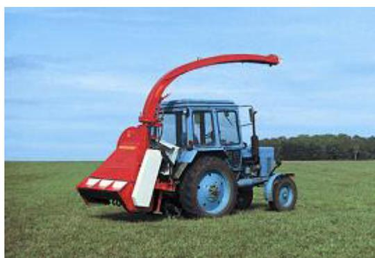
**Косилка-измельчитель КИН-Ф-1500 «СН15»** предназначена для скашивания зеленых трав, кукурузы, и других силосуемых культур высотой не более 1,2 м. с одновременным измельчением и погрузкой в транспортные средства. Может быть использована для скашивания ботвы картофеля. Агрегируется с тракторами класса 1,4 т.с. (МТЗ 80/82 и др.).
