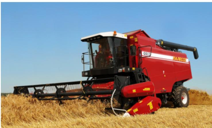
**Жатки ЖЗС** предназначены для уборки сои, зерновых колосовых, зернобобовых, крупяных культур и позволяют обеспечить минимальные потери зерна при уборке сои. По рабочим органам и основным конструктивным элементам жатки для уборки сои максимально унифицированы с жатками для
