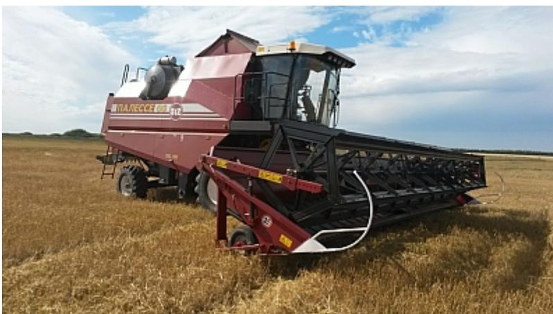
**Жатки ЖТ-9, ЖТ-9-1, ЖТ-12** предназначены для скашивания и укладки в валок, а так же уборки прямым комбайнированием зерновых колосовых культур, семенников трав, крупяных культур, рапса.
