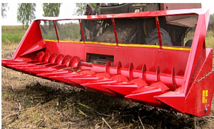
**Жатки ПС-8 и ПС-12** предназначены для уборки подсолнечника. Высокая производительность и бережное отношение к зерну подсолнечника – главные особенности жаток ПС-8 и ПС-12, которые одинаково эффективно работают во всех зонах возделывания как при уборке высокорослых, так и низкорослых сортов. Жатки могут
