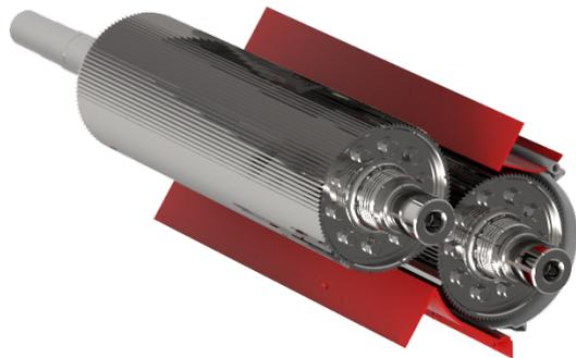
Доизмельчающее устройство OPTI ROLL CRACKER с зубчатыми вальцами и оптимальным диаметром 196 мм, позволяет эффективно осуществлять дробление зерна и расщепление стержней початков, как при мелкой, так и крупной резке кормовой массы. Данное решение позволяет Вам, имея на вооружении один вариант доизмельчителя, эффективно работать на максимально большом диапазоне резки без временных и финансовых затрат на смену зернодробилки.
