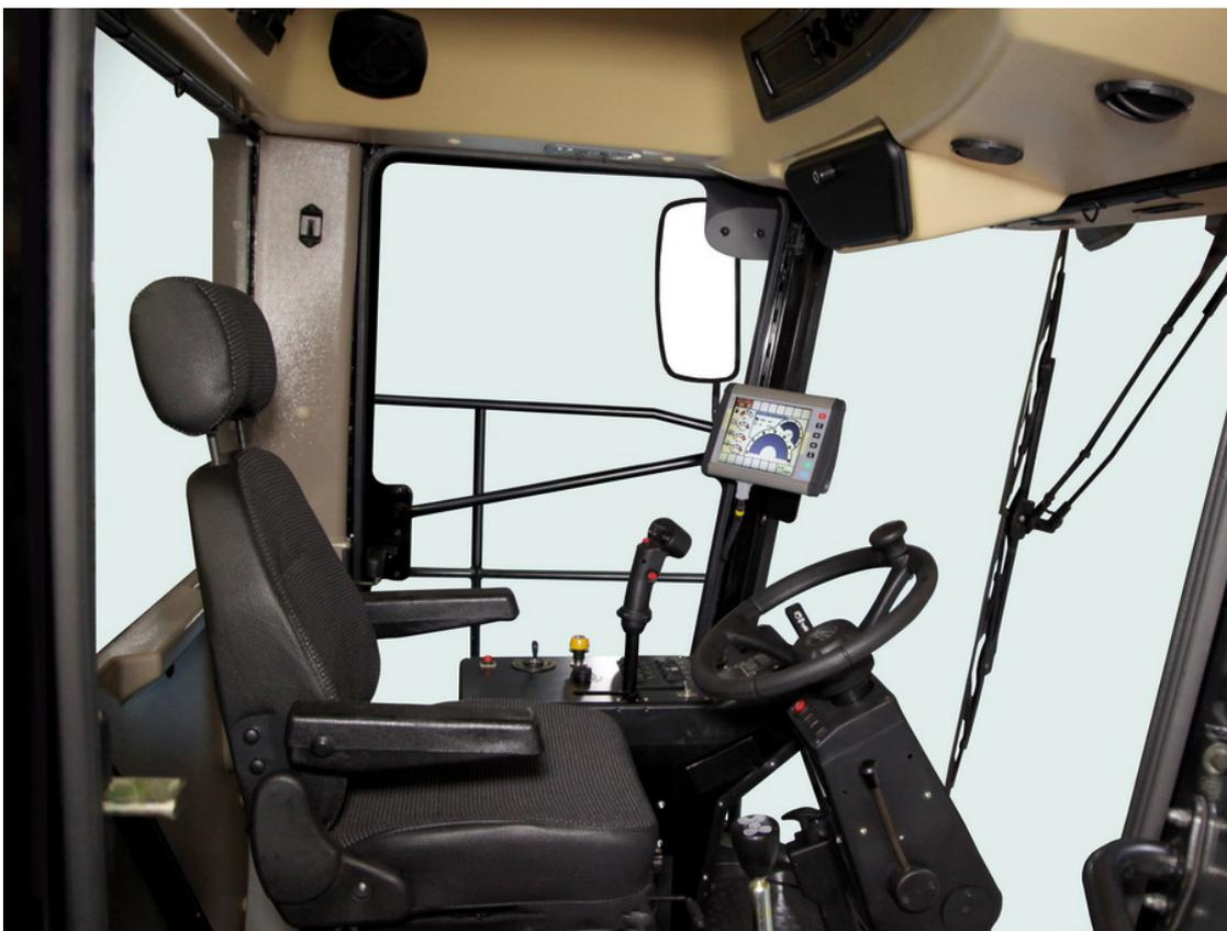
Информационная система бортового компьютера HARVEST OFFICE делает работу комбайнера максимально эффективной и комфортной. Система HARVEST OFFICE помогает управлять и наблюдать в реальном времени за состоянием основных функциональных узлов комбайна, контролировать рабочие органы, двигатель, трансмиссию, ход исполнения рабочих и сервисных операций, а также информирует о наличии предупредительных и аварийных ситуаций.
