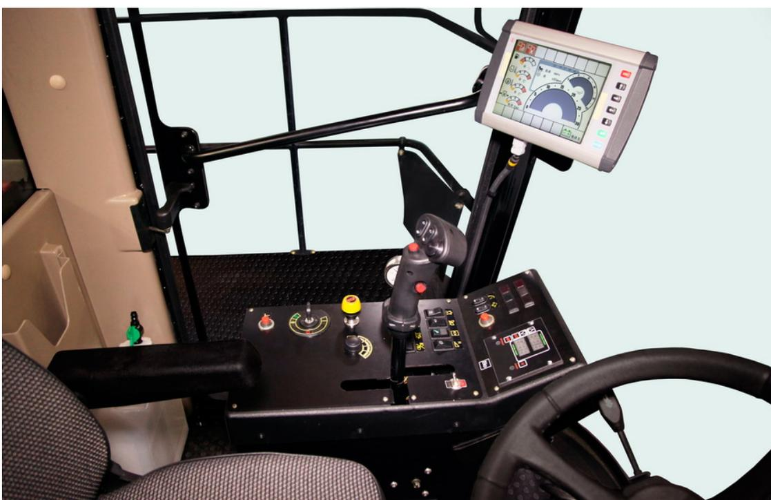
Из кабины комбайна при помощи системы AUTOSHARP можно осуществлять автоматическую заточку ножей измельчающего барабана. AUTOSHARP повышает качество измельчения кормов и производительность комбайна, при этом в значительной мере снижается расход топлива, а Вы экономите время и деньги. Количество циклов заточки задаётся с пульта управления в кабине.
