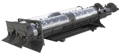
Высокая производительность комбайна GH800 достигается за счёт двух роторов соломосепаратора диаметром 450 мм и длиной 4200 мм, которые врачаются во встречных направлениях, тем самым создавая большую центробежную силу, обеспечивают эффективное, быстрое и бережное выделение остаточного зерна для того, чтобы Вы могли получить максимум урожая.
