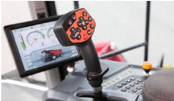
Современный многофункциональный джойстик управления комбайном MULTI GRIP, интегрированный в подлокотник, даёт Вам возможность с лёгкостью управлять процессом уборки. Чтобы сделать Ваш труд проще и эффективнее, в комбайне предусмотрена система CROP PRESET, позволяющая автоматически настраивать рабочие органы комбайна (обороты молотильного барабана, зазор подбарабанья, обороты вентилятора, зазоры верхних и нижних решёт) при смене культуры.
