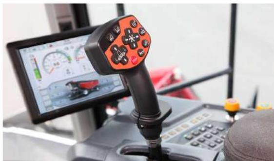
Современный многофункциональный джойстик управления комбайном MULTI GRIP, интегрированный в подлокотник, даёт Вам возможность с лёгкостью управлять процессом уборки. Чтобы сделать Ваш труд проще и эффективнее, в комбайне предусмотрена система CROP PRESET, позволяющая автоматически настраивать рабочие органы комбайна (обороты молотильного барабана, зазор подбарабана, обороты вентилятора, зазоры верхних и нижних решёт) при смене культуры.
