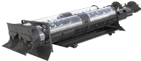
Высокая производительность комбайна GN800 достигается за счёт двух роторов соломосепаратора диаметром 450 мм и длиной 4200 мм, которые вращаются во встречных направлениях, тем самым создавая большую центробежную силу, обеспечивают эффективное, быстрое и бережное выделение остаточного зерна для того, чтобы Вы могли получить максимум урожая.
