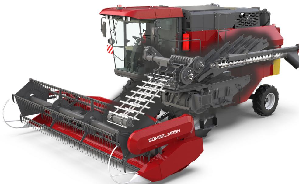
Такая схема, кроме завидной технологической надёжности, обеспечивает универсальность применения и простоту обслуживания. Трение, создаваемое барабаном в 600 мм, мягко и эффективно выделяет зерно даже из высокосоломистых культур.
