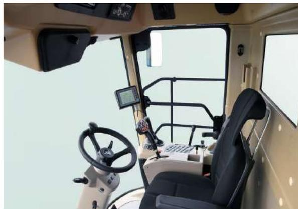
Также для облегчения Вашего труда и повышения его эффективности в комбайне предусмотрена система CROP PRESET, позволяющая автоматически настраивать рабочие органы комбайна (обороты молотильного барабана, зазор подбарабья, обороты вентилятора, зазоры верхних и нижних решёт) при смене культуры.
