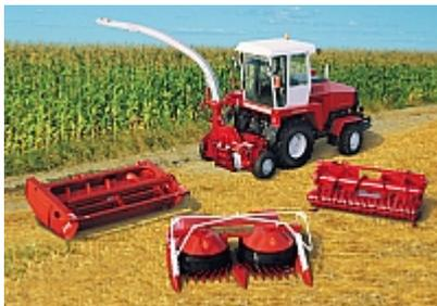
Комплекс К-Г-6 включает в себя универсальное энергосредство УЭС-2-250, УЭС 2-250А, УЭС-280, УЭС-2-280 или УЭС-2-280А и агрегируемый с ним полунавесной кормоуборочный комбайн КПК-3000 с комплектом адаптеров.
