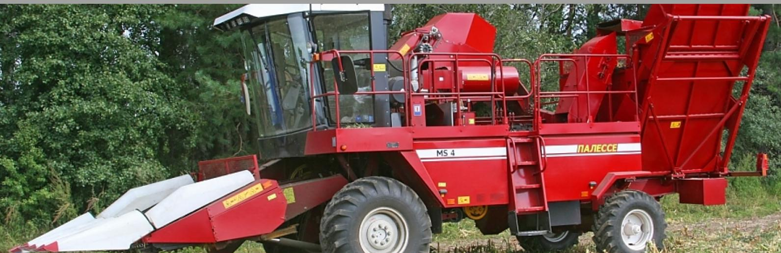
Комбайн початкоуборочный ES4 предназначен для уборки початков кукурузы в стадии полной спелости зерна влажностью до 25% с выполнением следующих технологических операций:
